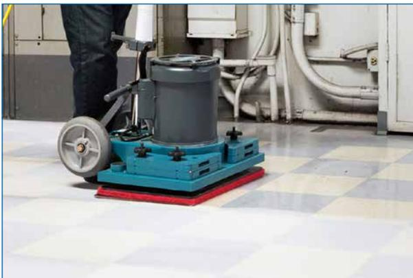
**4** Mueva la máquina en línea recta utilizando el método de tirar y jalar. Repita según sea necesario para eliminar completamente el acabado del piso.
