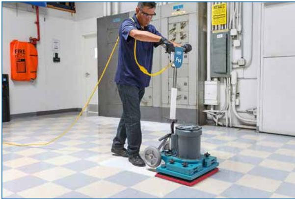
**2** Ajuste la manija a una posición cómoda, puede ser vertical o la altura de la cintura dependiendo de la preferencia del operador.
