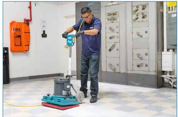
**3** Si su máquina incluye un interruptor de seguridad, presione el interruptor y apriete el mango. Si la máquina contiene control de polvo a bordo, encienda la aspiradora.
