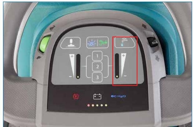
**3** Ajuste el control de la solución a la configuración más baja.
