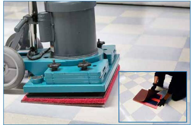
**1** Incline la máquina hacia atrás. Coloque la almohadilla de preparación marrón en el lado con velcro de la almohadilla de respaldo roja y luego coloque la almohadilla de respaldo en la parte inferior de la máquina. Baje suavemente la máquina.
