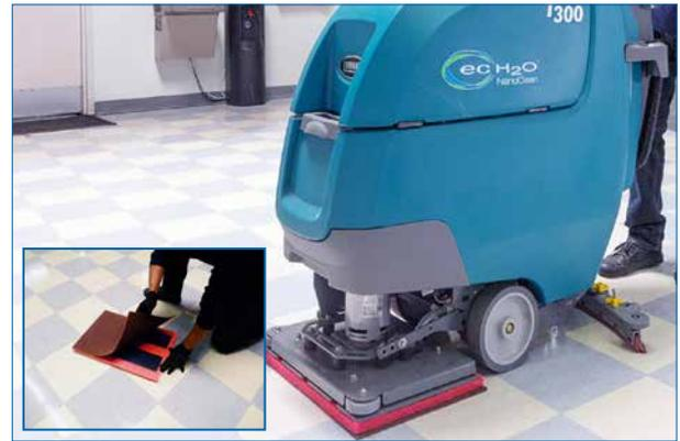
**1** Coloque la almohadilla de preparación marrón en el lado con velcro de la almohadilla de respaldo roja y luego coloque la almohadilla de respaldo en la parte inferior de la máquina.
